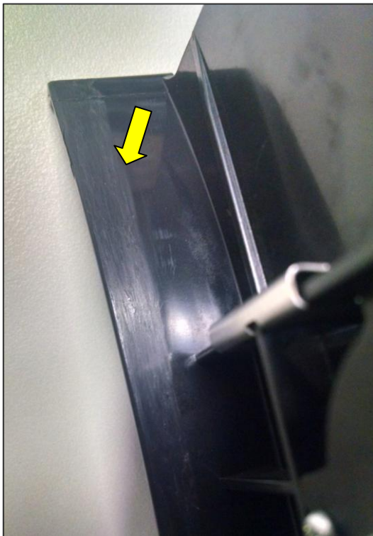
Sinais de desgaste no Trilho de Encaixe do Cartucho da Amostra
